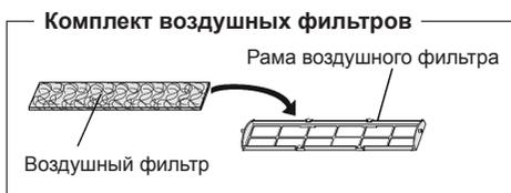
2. Задействуйте защелку на обоих краях фильтра и два крючка в задней части рамы для воздушных фильтров. Крючок (2 расположения в задней части)
